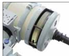
主鏡セル側面板を外した様子
