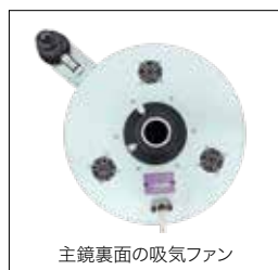
主鏡裏面の吸気ファン
