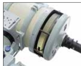
主鏡セル側面板を外した様子
