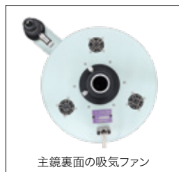
主鏡裏面の吸気ファン
