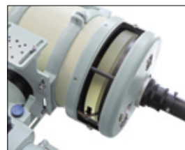
主鏡セル側面板を外した様子
